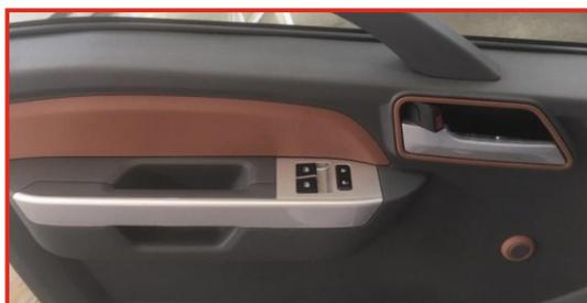
Нажмите кнопку электропривода дверей и окон, чтобы поднять или опустить стекло двери и окна.
