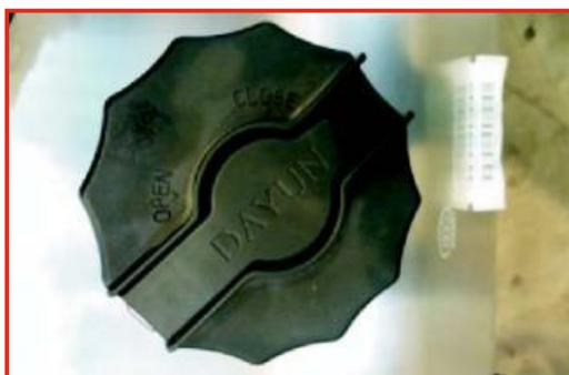
Крышка заливной горловины топливного бака расположена на топливном баке. Если повернуть ключ в положение OPEN, а затем вытянуть его, то крышку заливной горловины можно открыть, потянув ее наружу.
