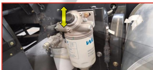
1. Ослабьте винт стравливания воздуха, нажимайте на ручной насос, установленный на топливном фильтре, вверх и вниз до тех пор, пока из винта стравливания воздуха не начнет вытекать топливо без пузырьков воздуха, и затяните винт стравливания воздуха.
