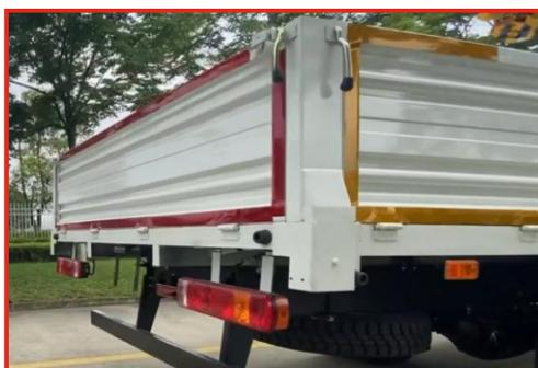
1. Проверьте болты и гайки соединительных деталей бортовой платформы. Одновременно проверьте и отрегулируйте гайки крюков бортов, чтобы плотно закрыть и уменьшить шум при движении.
