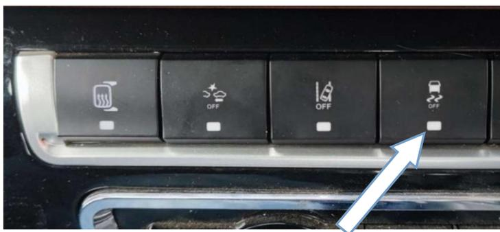
Водитель может выключить/включить функцию ESC с помощью переключателя на приборной панели
