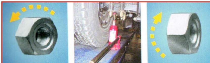
5. Ослабьте гайки колес ключом для гаек колес, но не снимайте их;
