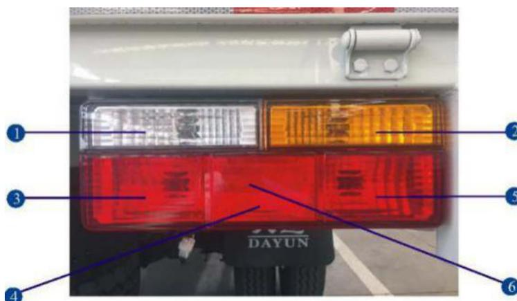
Задний комбинированный фонарь: 1.Фонарь заднего хода 2.Поворотник 3.Задняя противотуманная фара
