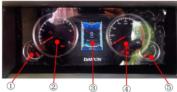
① Индикатор температуры воды ② Тахометр двигателя ③ Интерфейс дисплея с ЖК-экраной
