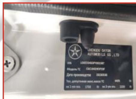
Пример расположения заводской таблички автомобиля (удлиненная кабина)
