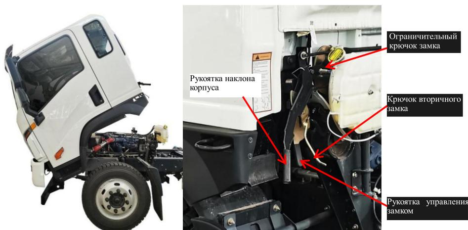
1. Кабина может быть откинута вверх и зафиксирована для облегчения технического обслуживания.
