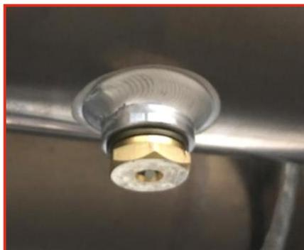
При нажатии на педаль тормоза, автоматический сливной клапан автоматически сбрасывает масло и водяные загрязнения, исключая необходимость ручного слива.
