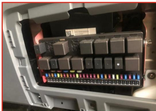
1. Блок предохранителей в кабине расположен в отверстии доступа под приборной панелью. Проверку и замену предохранителей и реле можно произвести, открыв крышку блока предохранителей.
