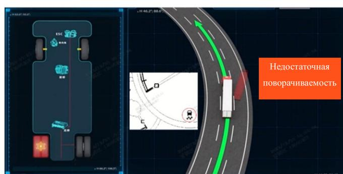
При чрезмерном повороте или недостаточной поворачиваемости автомобиля контроллер ESC активирует систему и выведет на прибор индикатор активации ESC.
