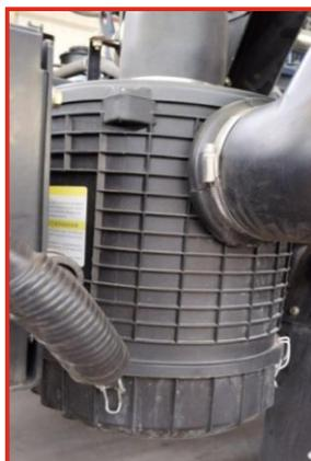
Засорение фильтрующего элемента воздушного фильтра приводит не только к снижению выходной мощности двигателя, но и к увеличению расхода топлива и появлению черного дыма. Поэтому воздушный фильтр должен обслуживаться следующим образом.
