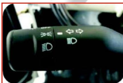
Управление следующими лампами осуществляется поворотом переключателя управления освещением (верхняя часть рукоятки) против часовой стрелки в два положения:
