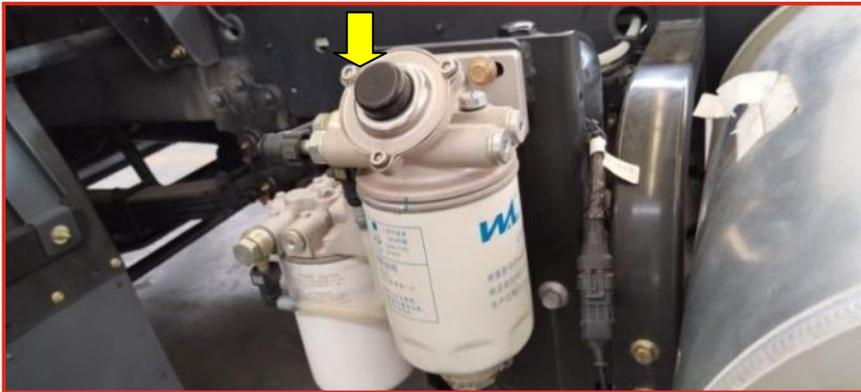
Если индикатор воды на топливном фильтре горит, необходимо произвести слив воды в соответствии со следующими действиями:
