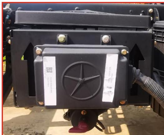
Главный выключатель питания расположен под блоком предохранителей, рядом с аккумулятором на левой или правой стороне рамы.
