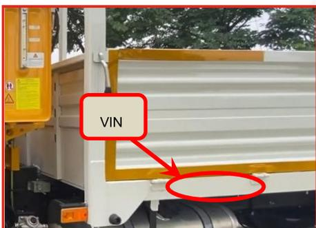
Пример расположения гравировки VIN-кода на бортовых грузовиках
