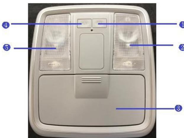
① Выключатель лампы освещения двери ② Внутреннее освещение ③ Бокс для очков
