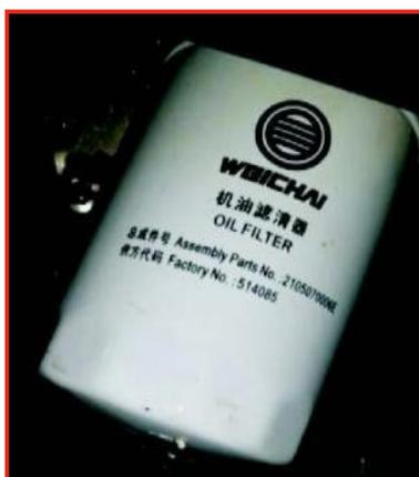
При замене масла в системе смазки одновременно заменяется и фильтрующий элемент.
