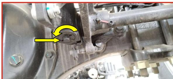
В случае неисправности, например, блокировки колеса или чрезмерного тормозного зазора, снимите маленький штифт, соединяющий верхнюю соединительную втулку автоматического регулировочного рычага с шатуном, закрепите шатун на корпусе с помощью хомутов и вручную приведите в действие автоматический регулировочный рычаг для ручной регулировки тормозного зазора.
