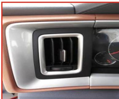
Перемещайте вентиляционную решетку для регулировки вентиляционного отверстия вверх, вниз, влево и вправо. Регулировочная ручка может использоваться для управления открытием или закрытием вентиляционных отверстий.
