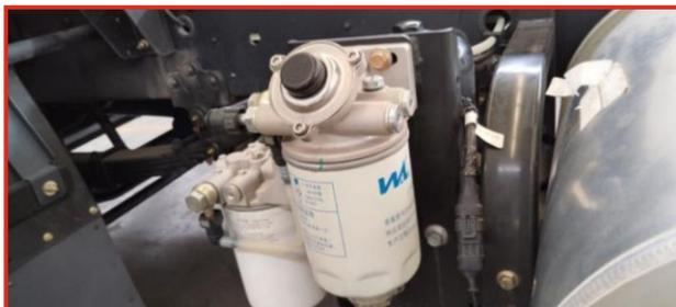
1. Поверните фильтр против часовой стрелки с помощью ключа для фильтра, чтобы ослабить его.
