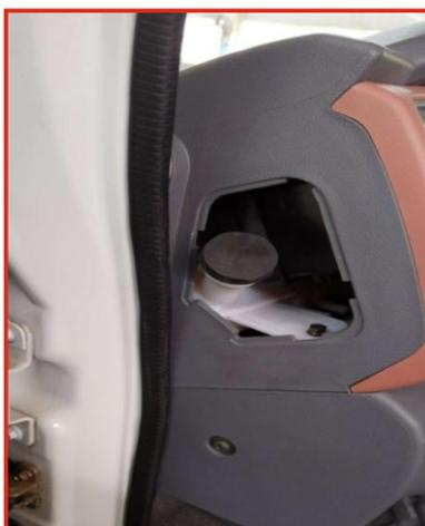
Бачок для жидкости установлен рядом с приборной панелью со стороны водителя.
