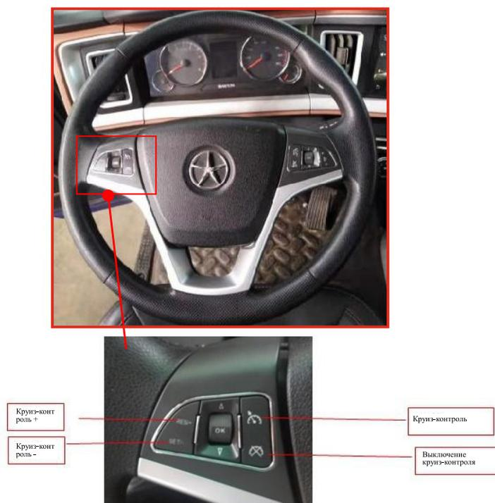
1. При соблюдении условий активации этой функции автомобиль начнет движение по круизу при нажатой клавише "Cruise" и последующем нажатии клавиши "Cruise-" или "Cruise+". Целевая скорость круиза - это скорость в момент нажатия клавиши.
