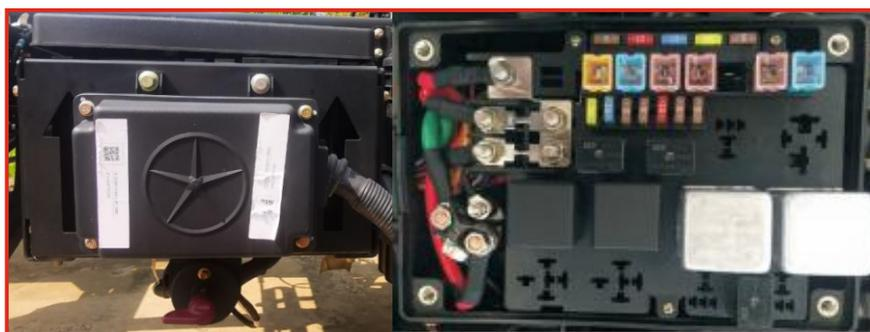
1. Жгут проводов блока предохранителей расположен справа от аккумулятора. Предохранитель и реле можно проверить и заменить, открыв крышку блока предохранителей.
