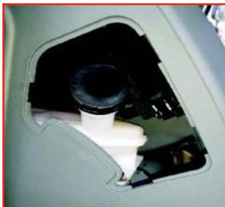
Проверьте, достигает ли уровень жидкости в бачке указанной отметки. Если уровень жидкости в бачке ниже отметки MIN, необходимо залить рекомендованную жидкость для гидравлических тормозов.
