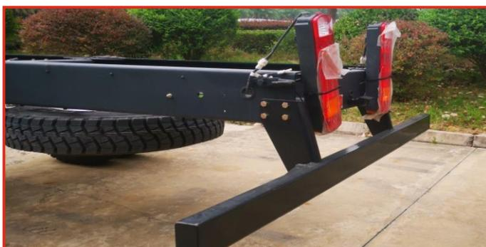
Узел соединения заднего отбойника с рамой
